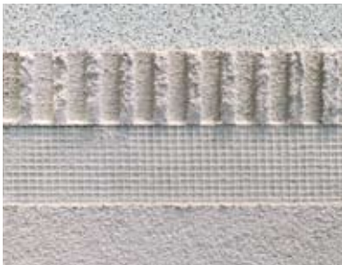
Schichtaufbau: Ytong Multipor Mineraldämmplatte, Leichtmörtel, Armierung mit Armierungsschicht aus Ytong Multipor Leichtmörtel und Ytong Multipor Armierungsgewebe
